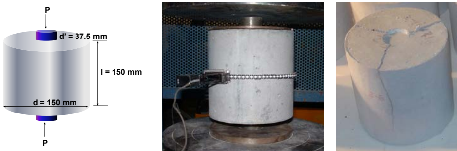
Figura 5. Ensayo de doble punzonamiento.
