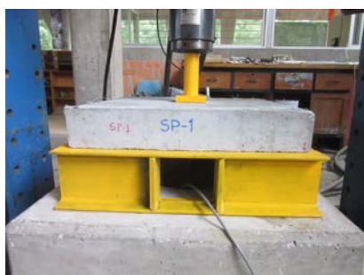
Figura 7. Ensayo de panel cuadrado EN 14488-5.
