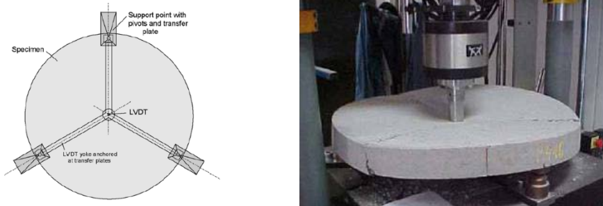
Figura 4. Ensayo de panel de sección circular.
