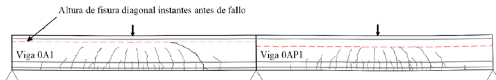
Figura 4. Comparación estado de carga vigas 0A1 y 0AP1
