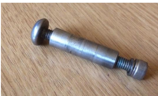
Ilustración 35 Cojinete de anclaje con el amortiguador
