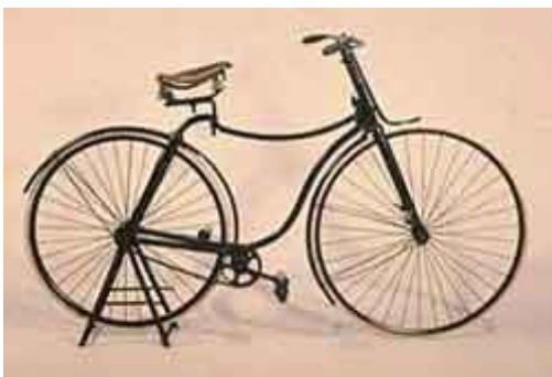
Ilustración 2 La bicicleta Rover fue la primera en incorporar una cadena de transmisión
