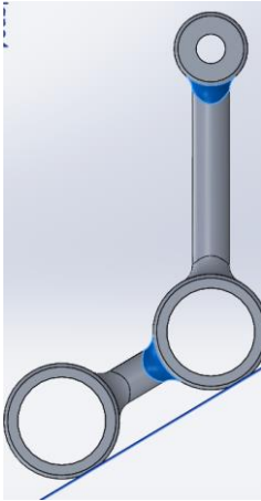
Ilustración 28 Redondeo de los anclajes
