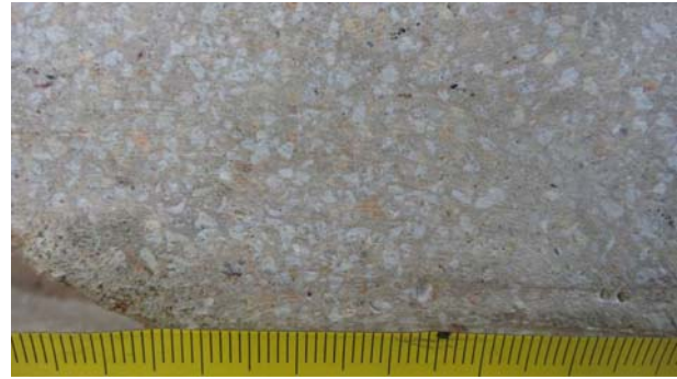
Figura 9. Detalle de la composición del mortero de la obra original donde se aprecia el tamaño y morfología del árido empleado por el escultor.
