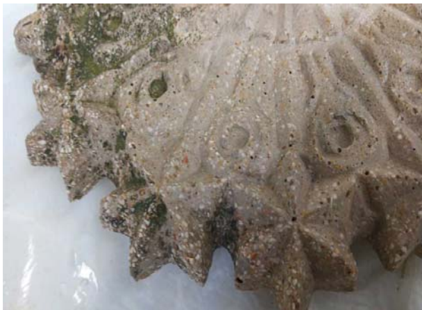
Figura 12. Detalle de la aureola en fase de limpieza biológica. Obsérvese la zona limpia con respecto a la zona con presencia de microorganismos. Tras la limpieza, se aprecia en la superficie todo el detalle ornamental.
