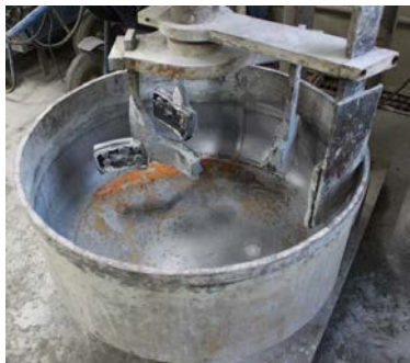
Figura 2. Betoneira utilizada na mistura.
