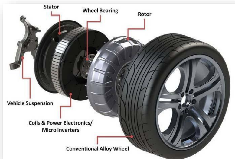
Ilustración 40: Sistema de frenada regenerativa integrada en la propia rueda
