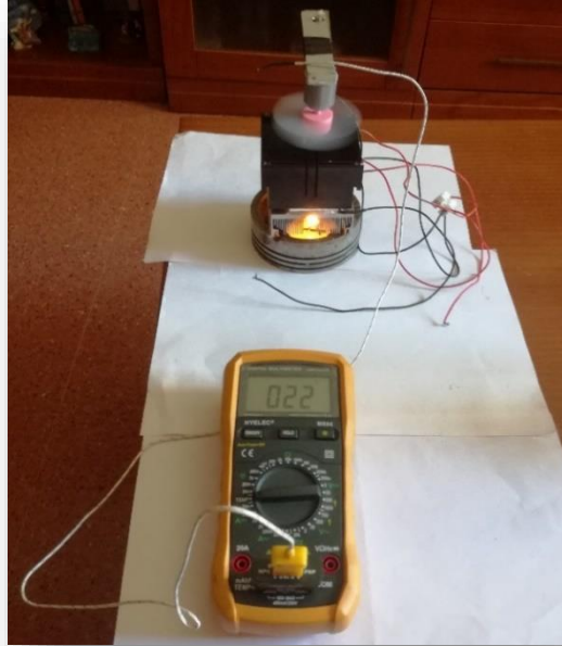
Medición de la temperatura ambiente
