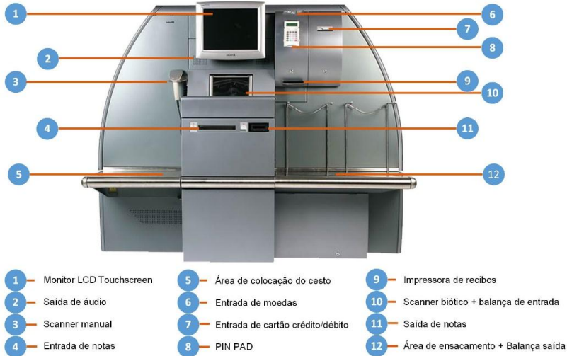
Fig. 2. Periféricos típicos de uma caixa self-checkout. Na figura, máquina Quick Way produzido pela (Adaptado ITAUTECH, 2017)
