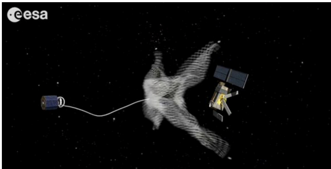
Figura 18. Representación de la captura de la futura misión e.Deorbit [51]
