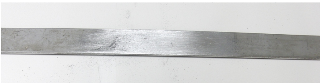
Figura A.6: Listón después de lijar con papel de grano grueso
