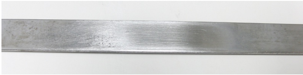
Figura A.7: Listón después de lijar con papel de grano fino
