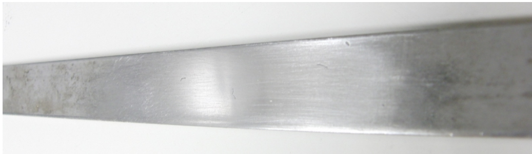
Figura A.7: Listón después de lijar con papel de grano fino
