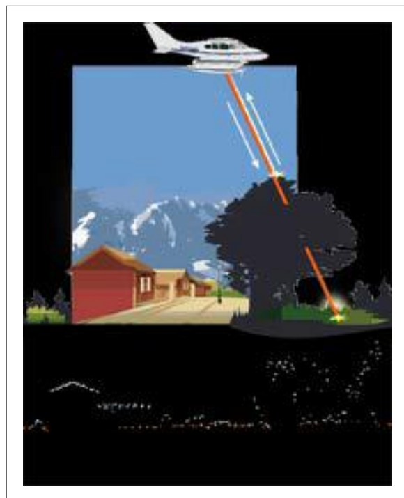
Figura 2.2: Penetración del láser en la vegetación.
