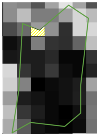
Figura 34: Solape de un píxel con el extremo de un polígono
