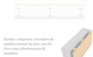
Paneles composite revestidos de madera natural de arce, encolados a una subestructura de madera
