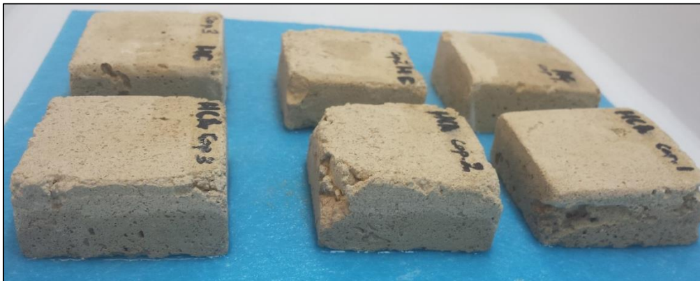
Figura 4.32. Transcurso del ensayo de absorción de agua por capilaridad sobre las probetas HC y HCA durante los 15 primeros minutos.
