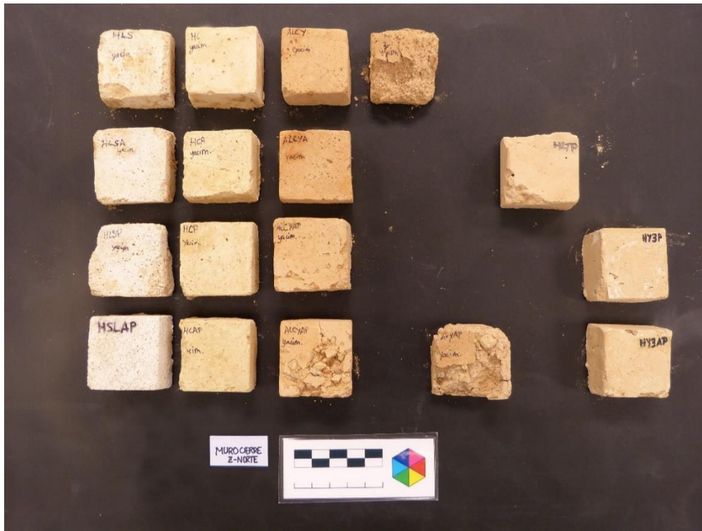
Figura 4.74. Estado de conservación de las probetas depositadas en la cara norte del muro de cierre.
