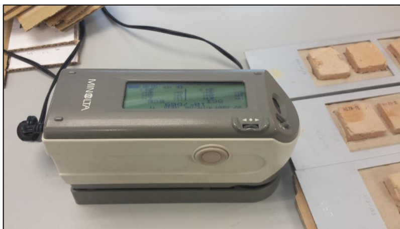
Figura 4.62. Medición del color a través del espectrofotómetro Minolta CM 2600d.
