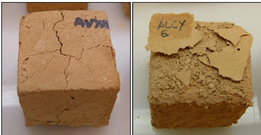
Figura 4.52. Detalle de las probetas durante el proceso del ensayo. A la Izquierda probeta grupo AVYA durante el 2º ciclo. A la derecha, estado de la probeta grupo ALCY tras la pérdida de la capa superficial durante el 6º ciclo.
