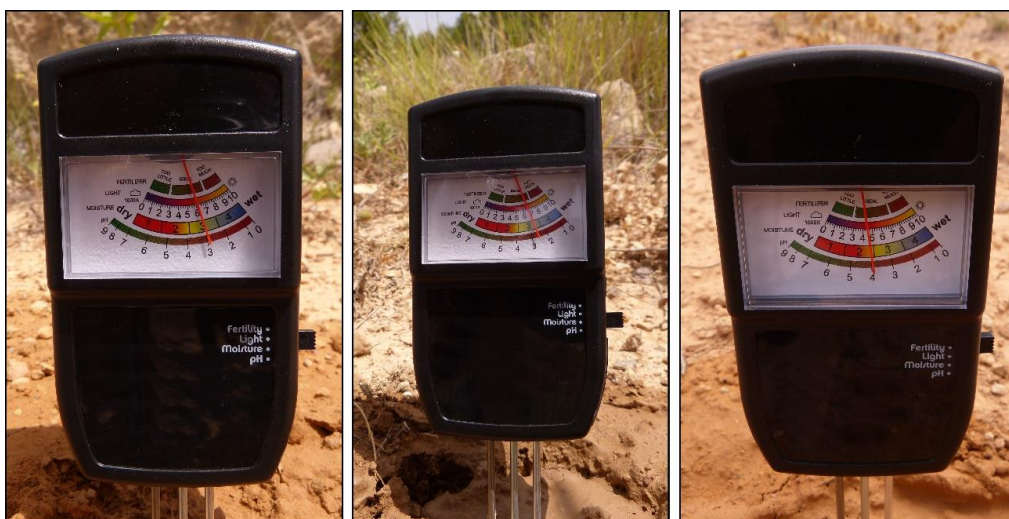
Figura 3.60. Medición de la humedad presente en el subsuelo 35 . De izquierda a derecha: localización 1, localización 2 y localización 3.
