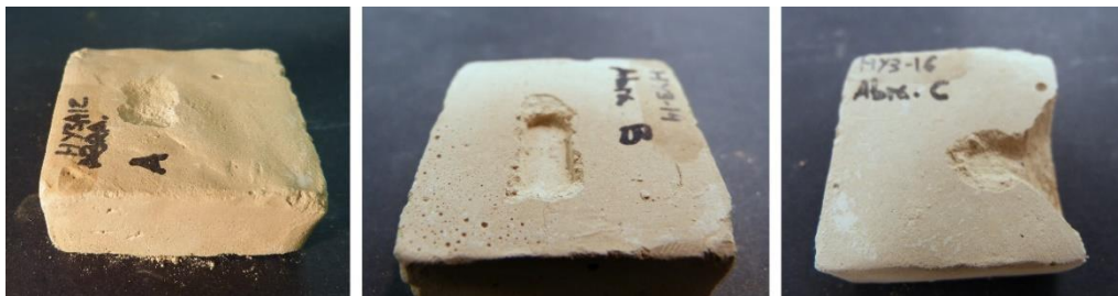
Figura 4.46. Detalle del deterioro de las diferentes probetas del grupo HY3 tras haber sufrido el efecto de los abrasímetros en cada una de las fases (de izquierda a derecha fases A, B y C).
