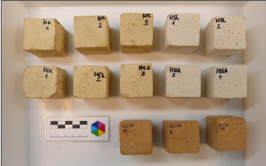
Figura 4.56. Estado final de las probetas que han resistido el ensayo de determinación de la resistencia a la cristalización de sales. Fuente: SANTOS et al. 2017, (en prensa).
