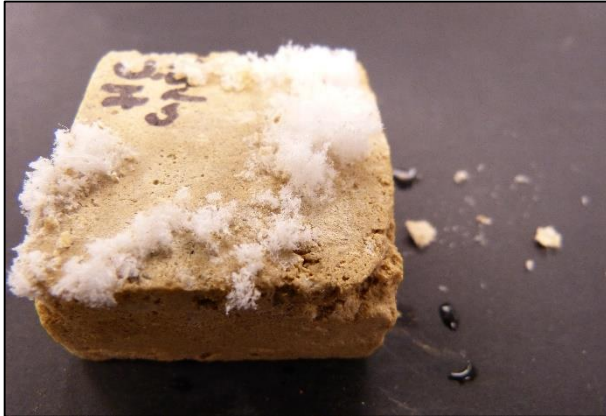
Figura 4.37. Visibles eflorescencias salinas en el exterior de la probeta HC.Cap-S-2 tras la evaporación del líquido, el consiguiente aumento de volumen y desprendimiento de fragmentos en forma de lascas.
