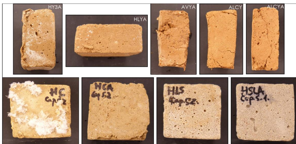
Figura 4.36. Aspecto final de las probetas tras el ensayo. Imágenes de detalle de una probeta de cada grupo que ha pasado el ensayo.
