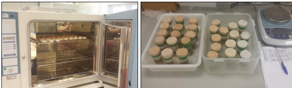
Figura 4.41. Inicio del proceso de secado de las probetas y parte de las probetas en transcurso del ensayo de determinación de la permeabilidad al vapor de agua.
