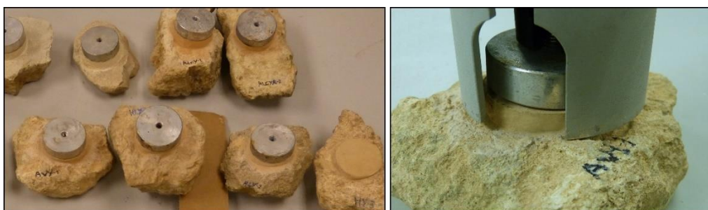
Figura 4.49. Preparación y transcurso del ensayo de determinación de la resistencia a la adherencia.
