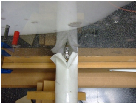
Fig. 15. Colocación del shaker sobre el elemento i en la Configuración 2
