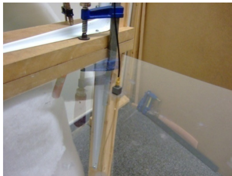
Fig. 14. Colocación del acelerómetro sobre el elemento j en Configuración 2
