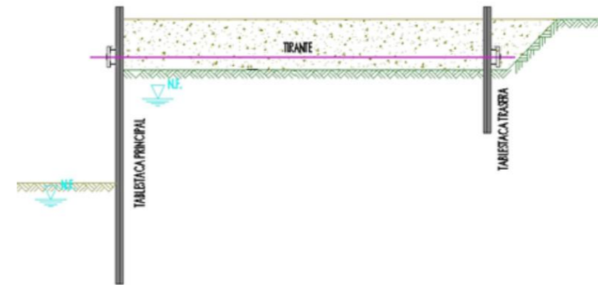
Ilustración 28: Tablestaca atirantada. Fuente: Página web de Ischebeck Ibérica.
