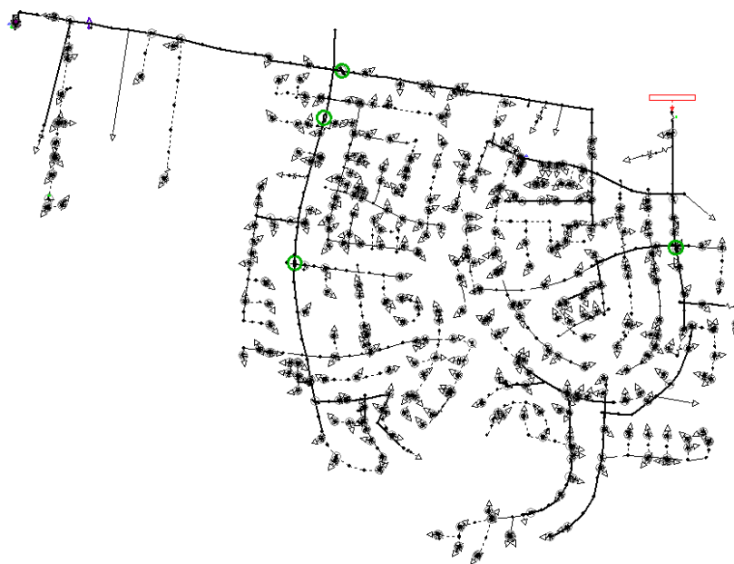
Figura 124. Ubicación óptima de reconectores (Nº=4). Puerto Azul
