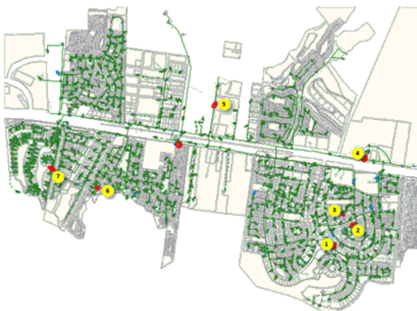
Figura 116. Escenario 1. Estado de cargabilidad zona ramificada
