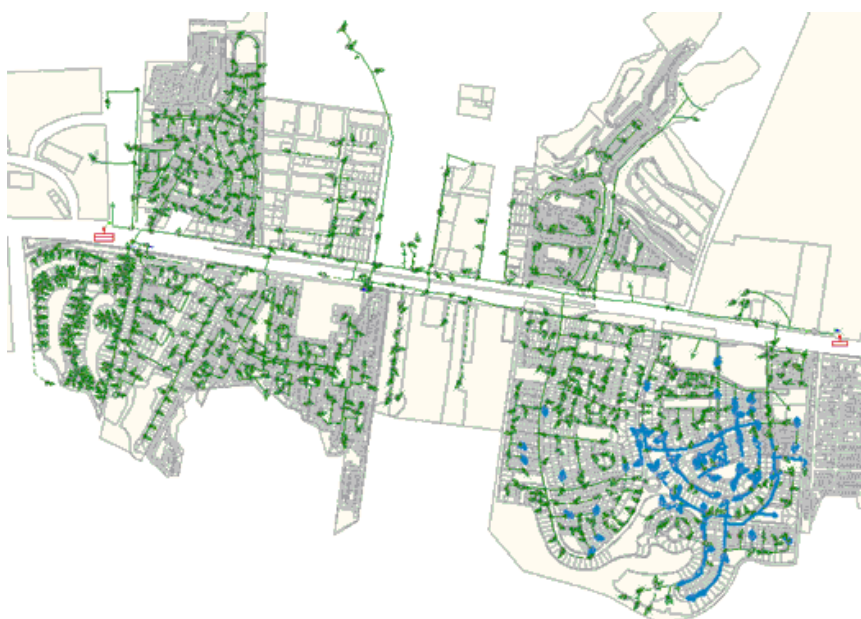
Figura 123. Escenario 1 reforzado. Estado de tensiones zona troncal
