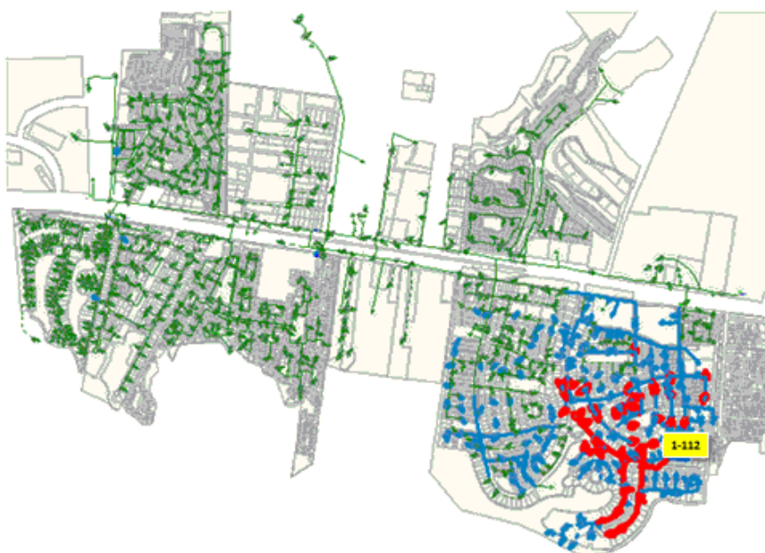
Figura 120. Escenario 3. Estado de tensiones zona troncal
