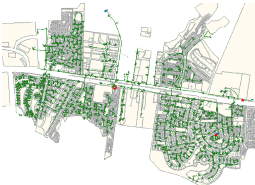
Figura 122. Escenario 1 reforzado. Estado de cargabilidad zona troncal
