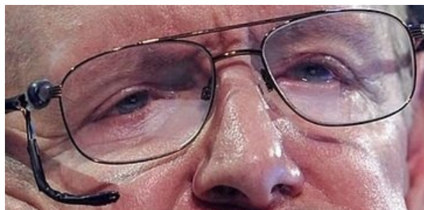
Figura 16. Gafas con sensor infrarrojo incorporado para fines de comunicación
