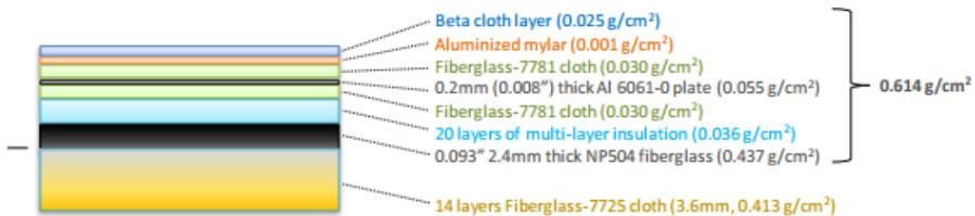
**Figura 5.28:** Aislamiento multicapa de densidad media-baja testado por la NASA.
