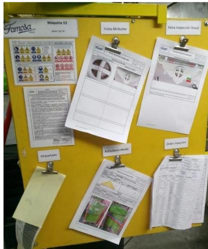
Figura 10. Panel para la colocación de la documentación en la planta de máquinas.
