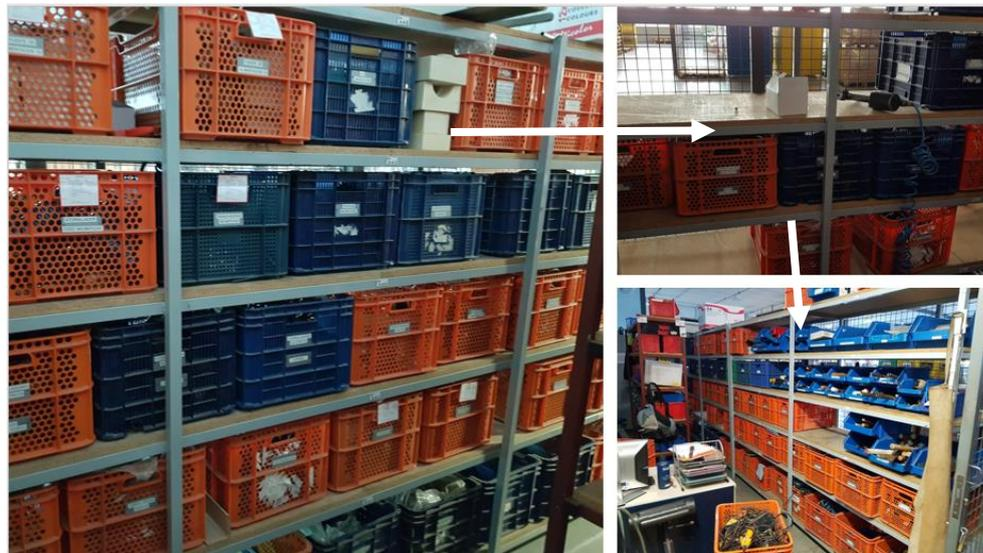
Figura 27. Retirada de banastas con herramientas y equipos innecesarios. Posteriormente se procedió a ordenar las banastas necesarias.
