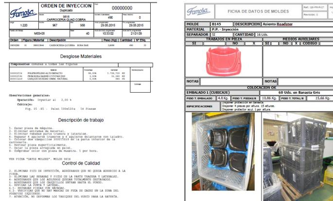
Figura 4. Orden de trabajo y Ficha de Datos de Molde utilizadas en la planta de inyección/soplado.
