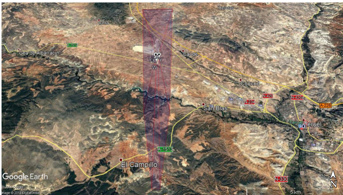
Figura 1.54: Superficies OAS para la pista 36
