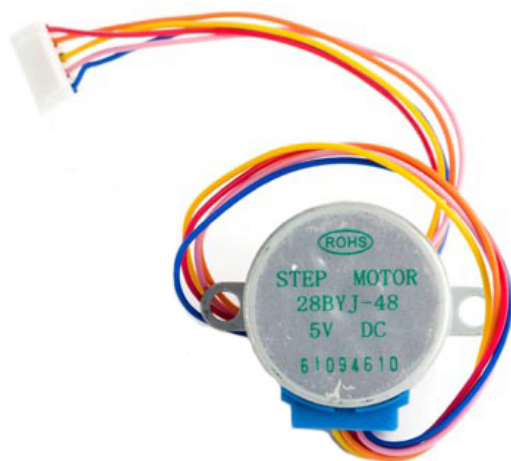
Figura 6. Motor paso a paso 28BYJ-48
