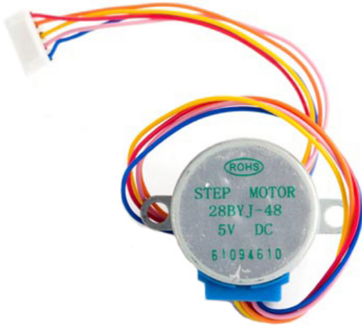
Figura 32. Motor paso a paso 28BYJ-48
