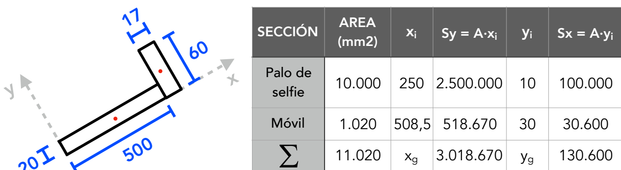
Figura 73. Cálculo del centro de gravedad del palo de selfie
