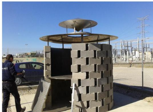
Figura 4. 2 Quemador para la obtención de ceniza en las instalaciones de la UPV.
