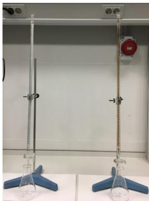
Figura 4. 10. Valoración de disoluciones
