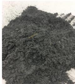
Figura 5. 1 Ceniza de paja de arroz luego de la molienda con el molino de jarras
