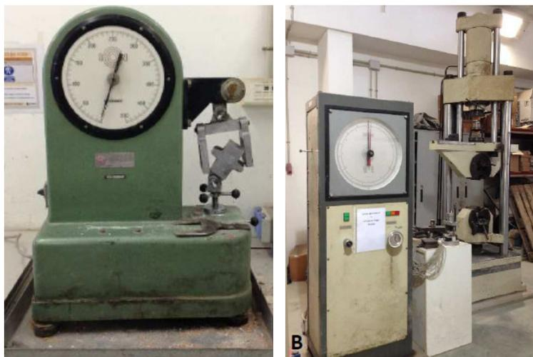
*Figura 4. 14 Prensas utilizadas para ensayos de flexión (Izquierda) y compresión (Derecha) de morteros*
