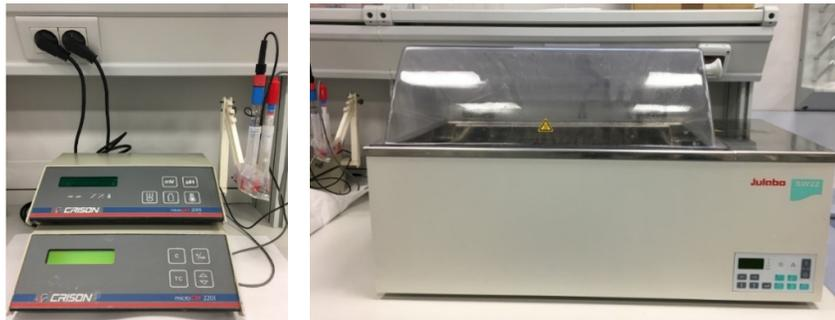
Figura 4. 8. Equipos utilizados. Izquierda : pHmetro y conductímetro , Derecha: Bañera térmica.
