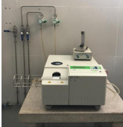
Figura 4. 12. Equipo para TGA 850 Mettler-Toledo
