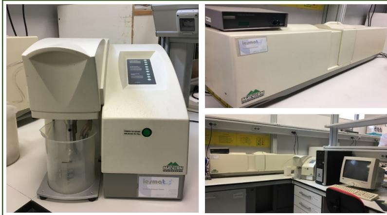
Figura 4. 5. El equipo para realizar el análisis de Partículas por Difracción de Rayos Láser.
