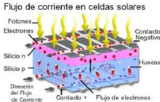
FIGURA 28. FUNCIONAMIENTO CELULA FOTOVOLTAICA
