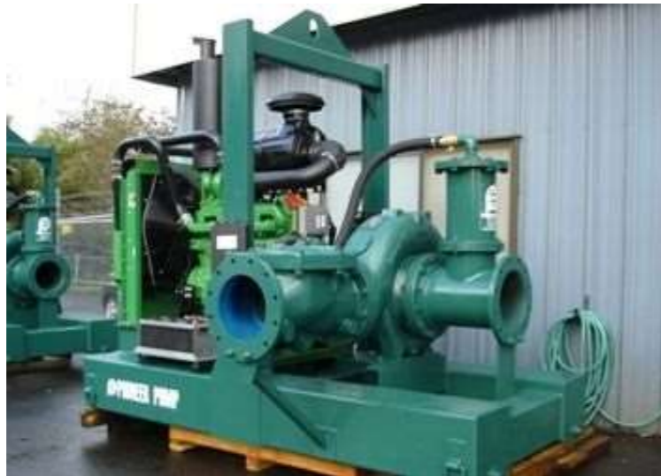
Figura 6. Bomba centrífuga de alto caudal
