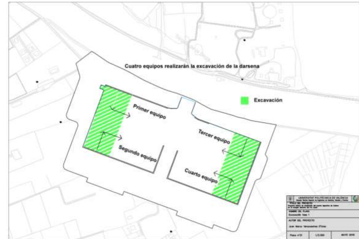
Figura 3. Primera fase de excavación
