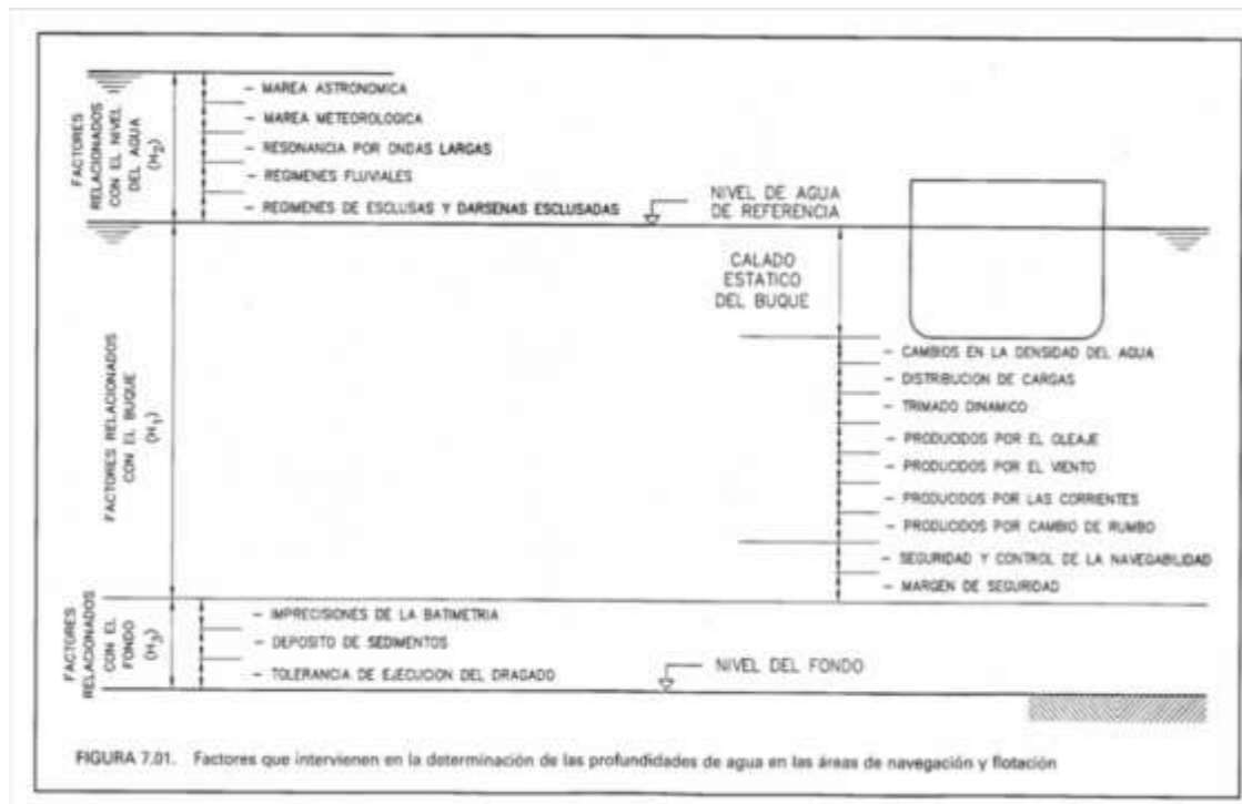
Figura 5. Factores que intervienen en la determinación de las profundidades de agua en áreas de navegación y flotación. ROM 3.1-99
