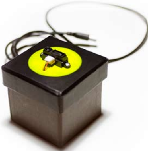
Fig. 110 - Theremin digital construido con Arduino y un sensor de infrarrojos.
