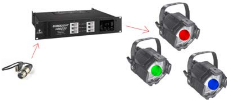
Fig. 139 - Esquema de conexión usb-dmx + dimmerDMX + focos de colores.
