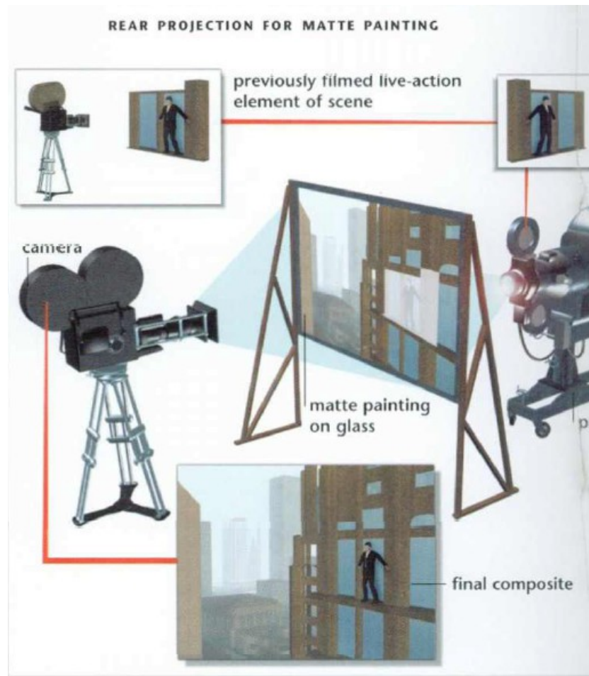
Esquema de la técnica de rear projection
