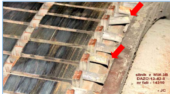
Fig.18. Barras rotas del rotor en un motor de 320 kW de un molino de carbón [ANTONINO 19 2007]
