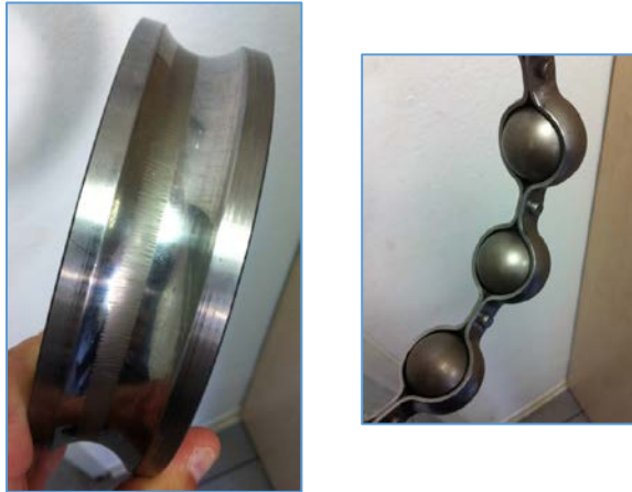
Fig.12. Aspecto de pista (izquierda) y bolas (derecha) en un rodamiento afectado por el paso de corrientes [ANTONINO 14 2017]
