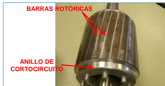
Fig.6. Foto del rotor de un motor de rotor de jaula de pequeña potencia [ANTONINO 12 2016]
