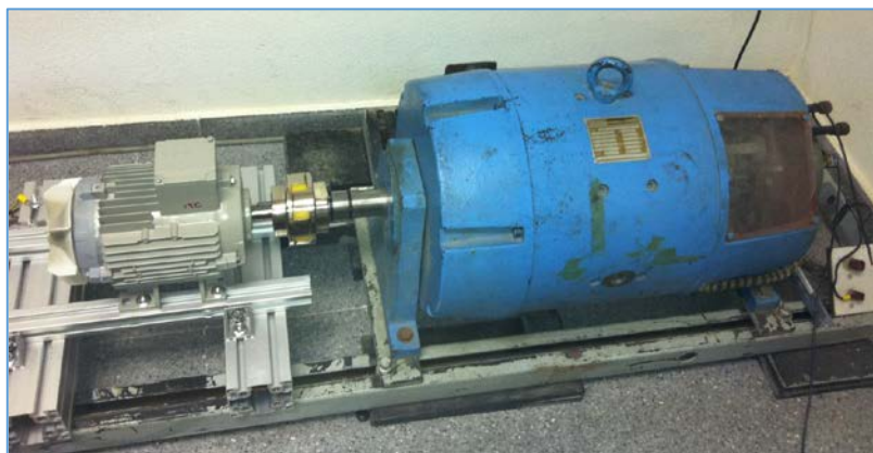
Fig.111. Fotografía del motor de inducción ensayado (izquierda) acoplado a la máquina de corriente continua (derecha). (Bancada 1).
