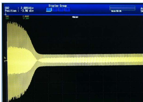
Fig.37. Forma de onda de la corriente de arranque en un arranque directo [ANTONINO 12 2016]
