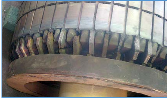
Fig. 28. Fotografía de rotor real con barras rotas en posiciones no adyacentes tomada de [RIERA-GUASP 2 2010].
