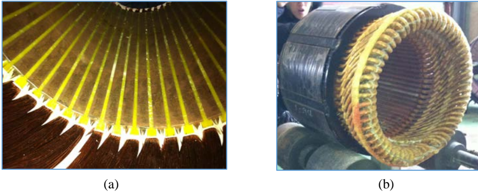
Fig.3. Devanado trifásico estático en motores de inducción: (a) Devanado aleatorio, (b) Devanado preformado.
