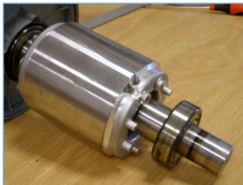
Fig. 107. Roturas de barras provocadas artificialmente en el rotor
