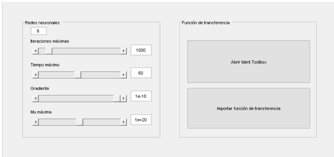
Fig. 7: Panel de configuración en el modo "Modelo motor", dividida en dos paneles secundarios: a la izquierda se configuran los parámetros del entrenamiento de la red mediante sliders y una entrada de texto para seleccionar el número de neuronas; a la derecha se elige cómo identificar la función de transferencia mediante dos botones.
