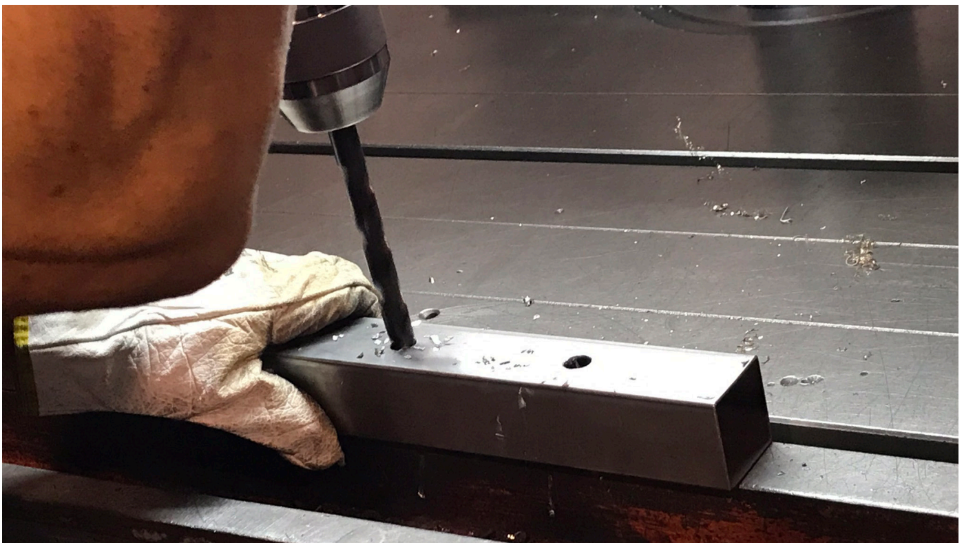
Imagen 10. Taladrado de tubos
