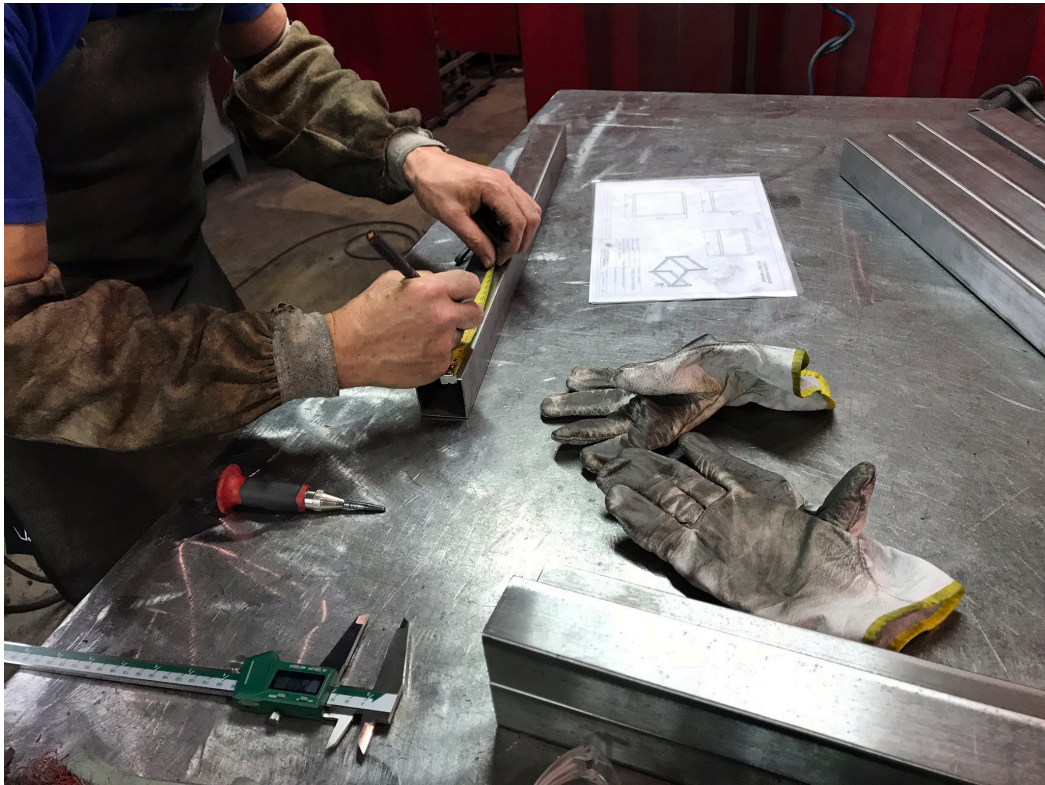
Imagen 3. Marcaje de tubos
