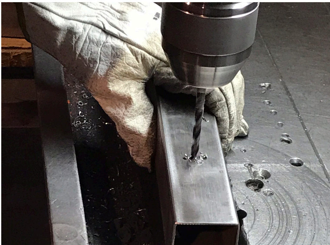
Imagen 8. Taladrado de tubos
