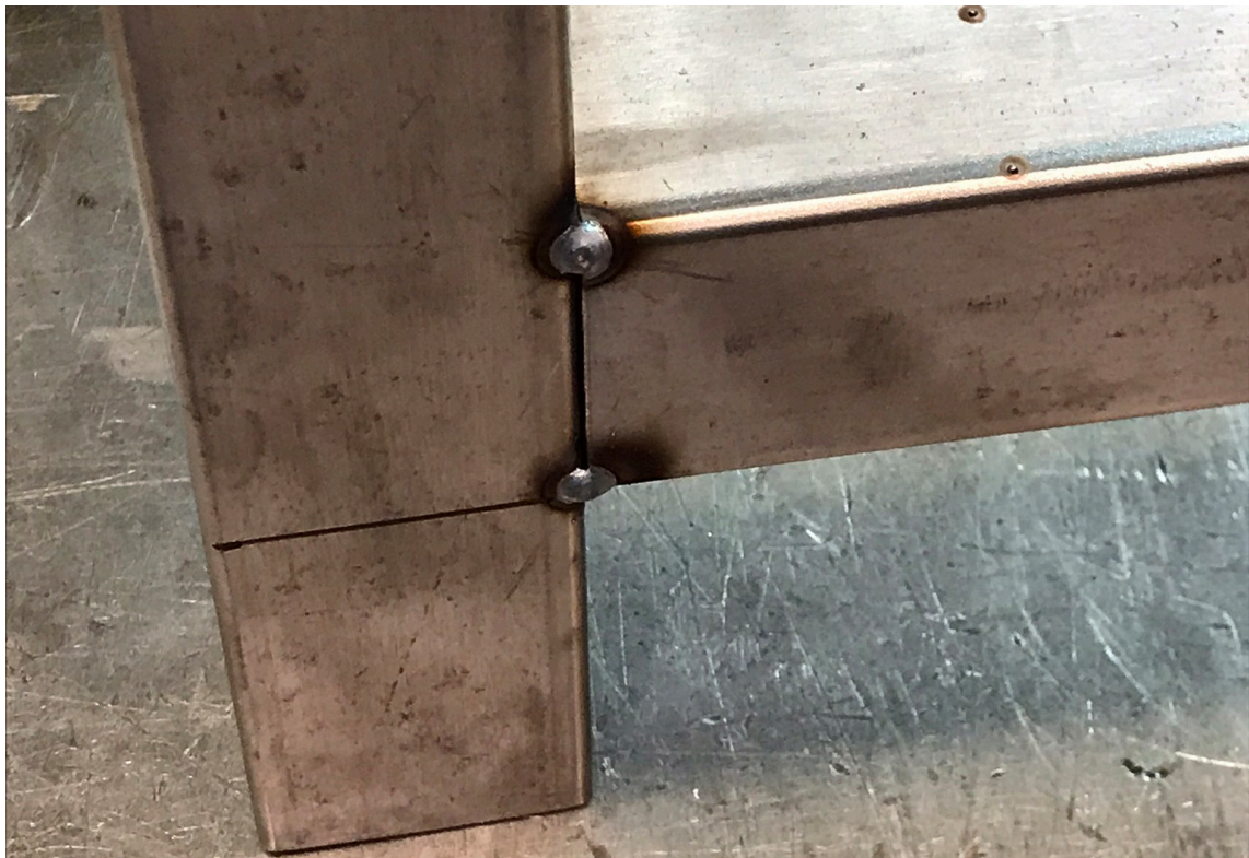
Imagen 14. Punteado de “Estructura 50x50x2”
