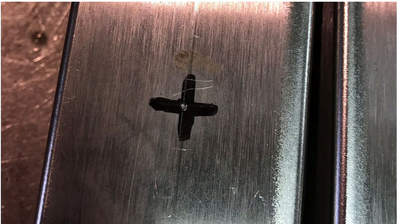
Imagen 6. Marcaje de tubos
