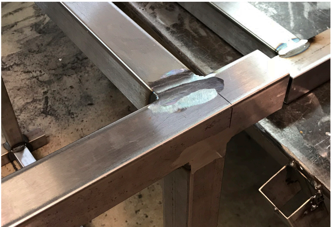
Imagen 18. Lijado cordones de soldadura
