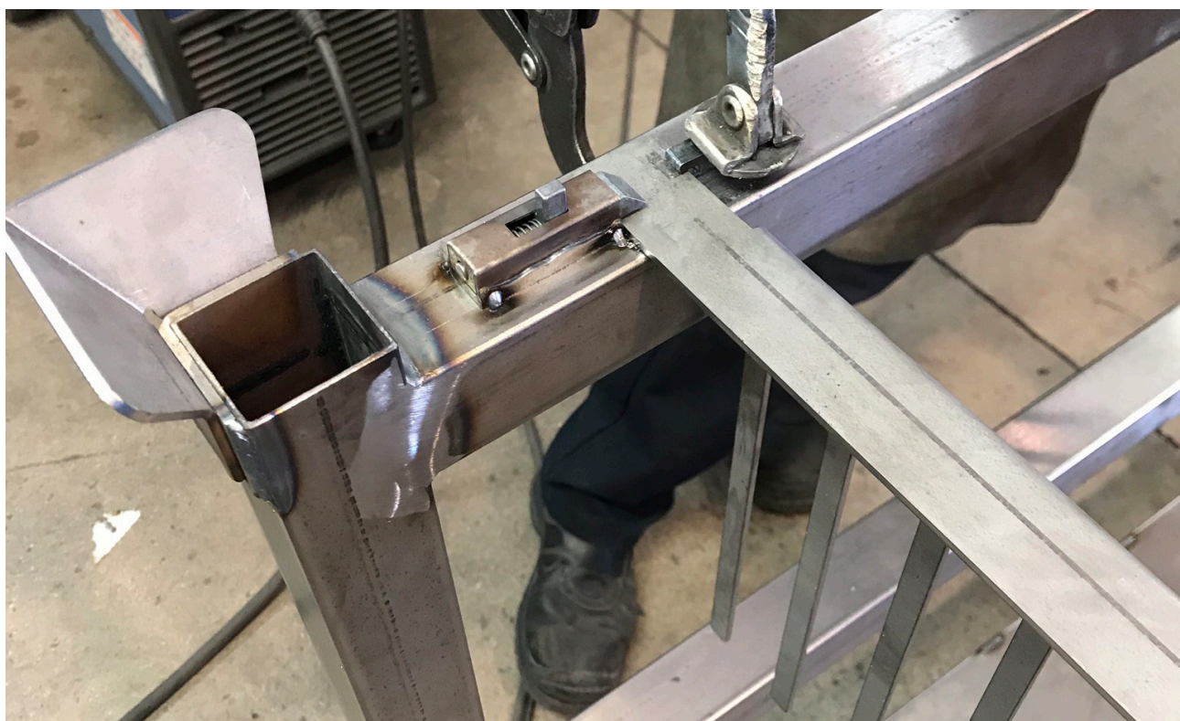
Imagen 25. Soldadura “Pestillo” con posición de “Peine”
