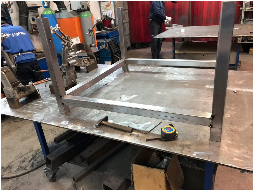
Imagen 15. Punteado de “Estructura 50x50x2”
