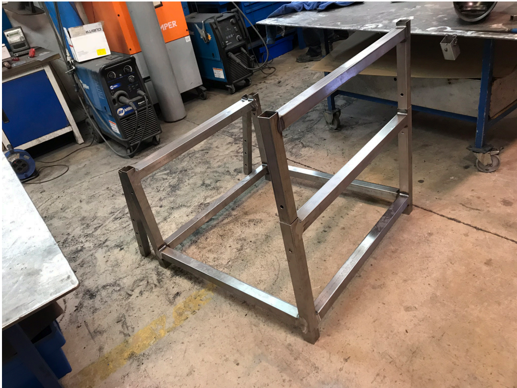
Imagen 19. Comprobación montaje estructura
