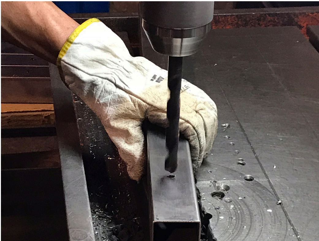
Imagen 9. Taladrado de tubos
