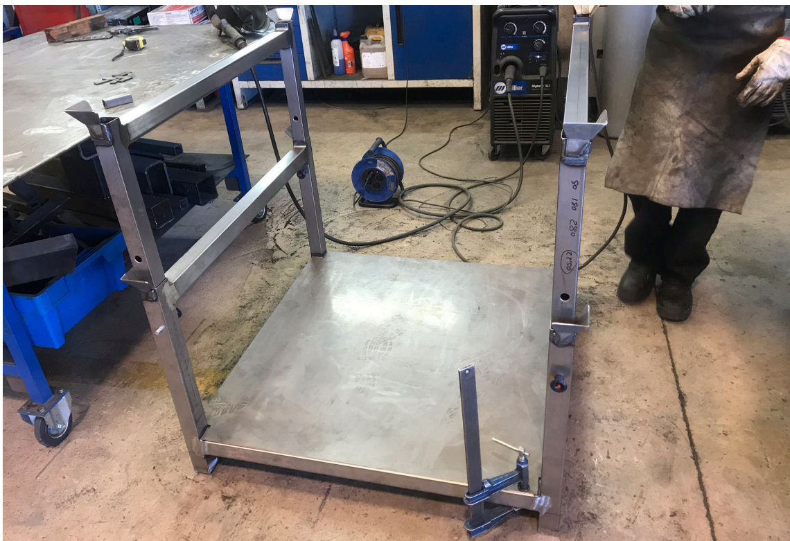
Imagen 24. Soldadura resto componentes rack
