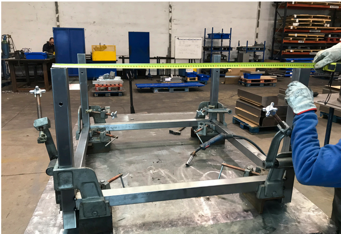
Imagen 12. Comprobación medida de “Estructura 50x50x2”
