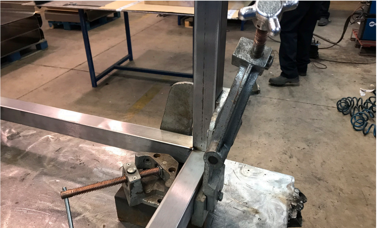
Imagen 13. Punteado de “Estructura 50x50x2”
