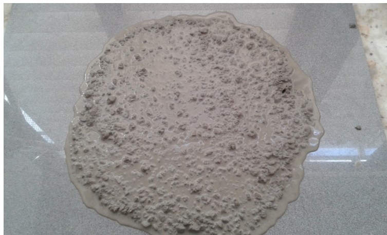
Ilustración 2. Hormigón autocompactante con claros signos de segregación. Además del halo de agua exterior se ve cómo los áridos no están bien cohesionados con la mezcla (Fuente: Rafa Calabuig, 2015)
