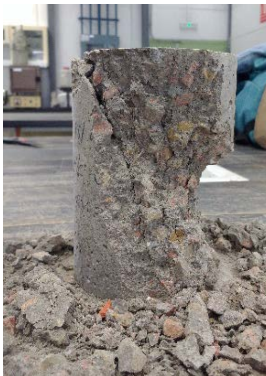
Ilustración 15. Forma de rotura de una probeta cilíndrica bajo compresión simple
