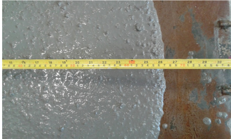
Ilustración 1. Hormigón autocompactante sin segregación (Fuente: Rafa Calabuig, 2015).
