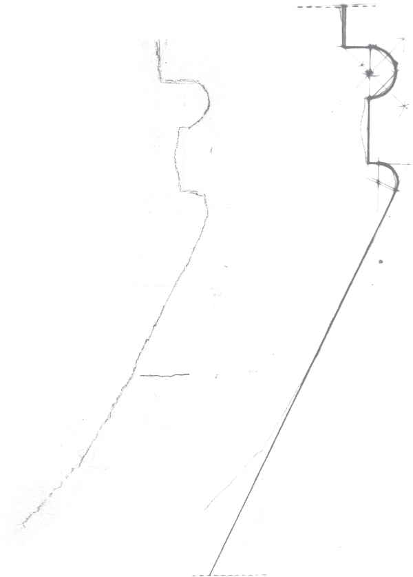
Fig. 77 - Perfil tomado in situ de la mensula, pared norte y puesta a escala.
