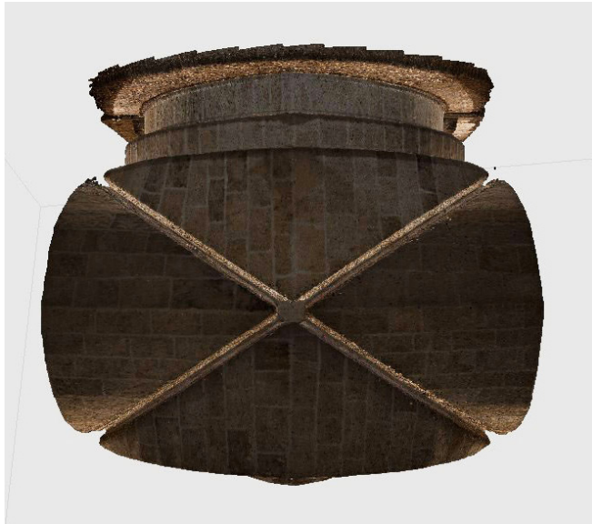
Fig. 107 - Vistas modelo 3D plementería realizadas con PhotoScan.
