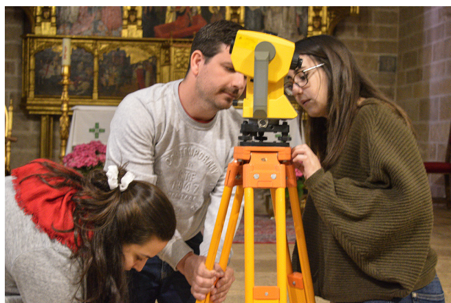
Fig. 62 - Patricia Alemany, Javier Plaza y M a José Sanchis nivelando la cabeza de la estación total.
