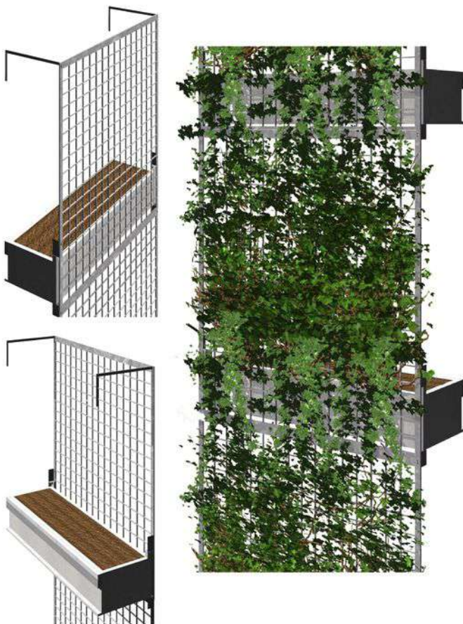
Imagen 38. Detalle Fachada vegetal de hiedras.
