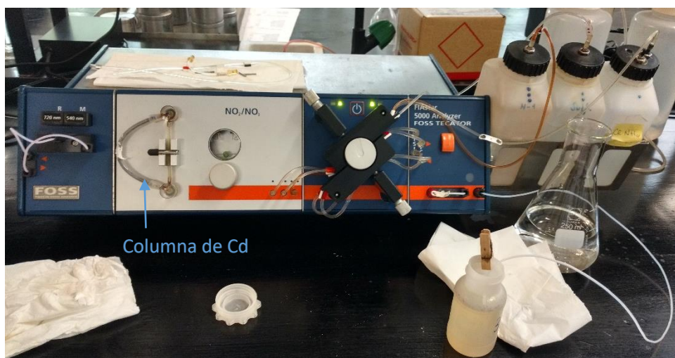
Figura 3.21. Equipo analizador FIAstar 5000 (modelo Foss Tecator), para la determinación de nitrato.
