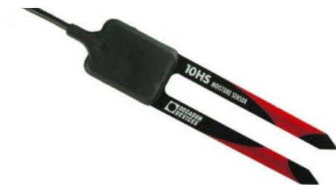
Figura 3.9. Sonda 10HS de Decagon Devices para medida de humedad del suelo.
