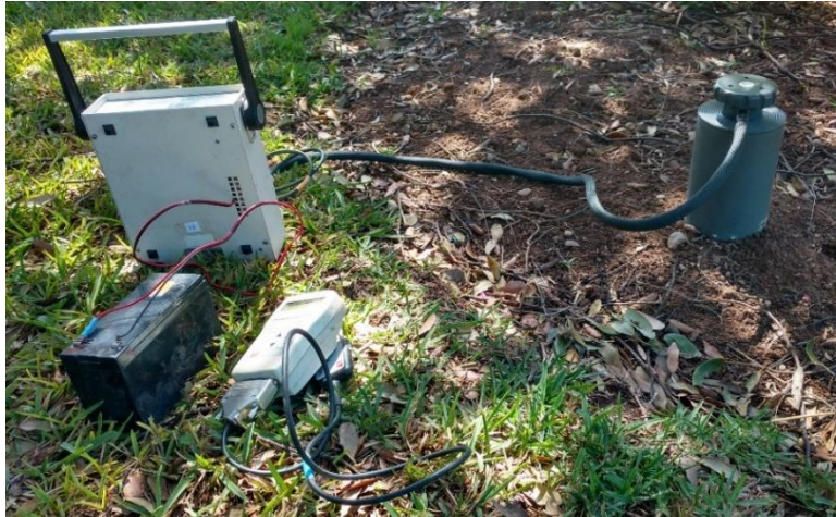
Figura 3.16. Medidor HH2 junto con EGM-4 utilizados en la respiración del suelo.
