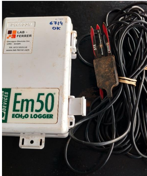
Figura 3.6. Caja del datalogger EM50 junto con un sensor de temperatura, humedad y CE del suelo.
