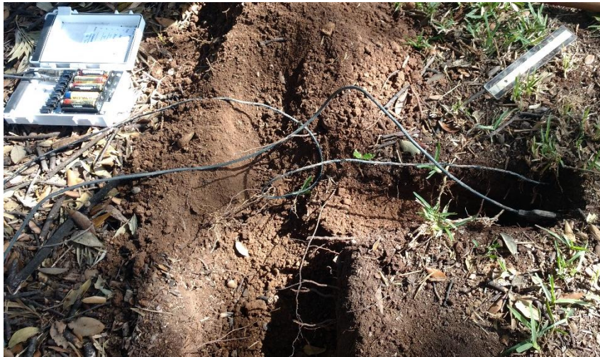
Figura 3.10. Sondas de temperatura y humedad enterradas a las dos profundidades.
