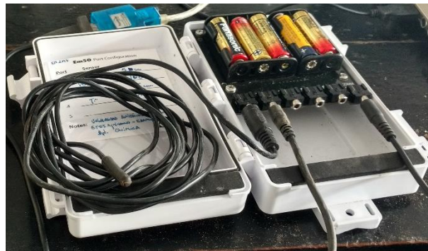
Figura 3.7. Caja del datalogger EM50 abierta, donde se visualizan las pilas y los diferentes puertos.
