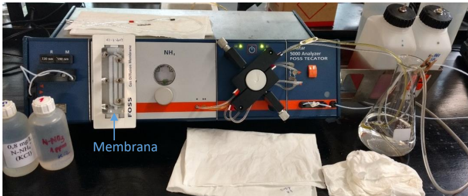
Figura 3.22. Equipo analizador FIAstar 5000 (modelo Foss Tecator), para la determinación de amonio.
