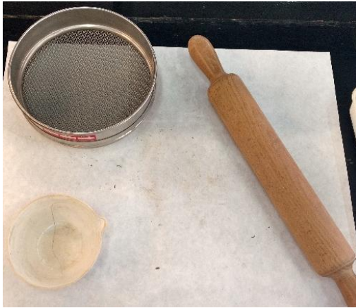
Figura 3.18. Material utilizado para el tamizado. Tamiz 2 mm, recipiente de porcelana y rodillo de madera.
