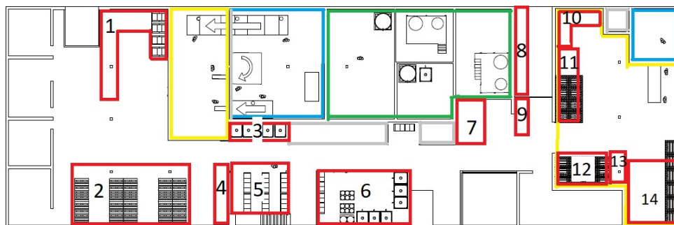
Figura 21: Planta de la fábrica. 1-Estanterías de cajas. 2-Playa de expedición. 3-Granel envasando y bombas. 4-Estanterías picking tapones, 5-Almacén granel fabricado. 6-Almacén materia prima 1. 7-Almacén materia prima 2. 8-Recepción de materias primas. 9-Producto rechazado. 10 Estanterías picking válvulas. 11-Cajas aerosol. 12-Playa de expedición aerosoles. 13-Producto cuarentena. 14-Almacén envases mas usados aerosol.
