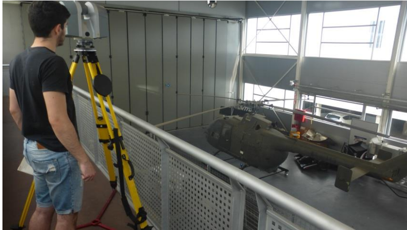
Figura 12. Proceso del levantamiento del helicóptero
