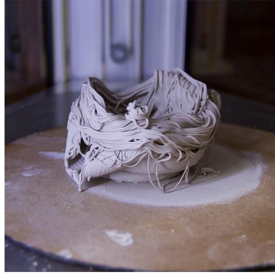
Imagen 99 Inicio de deformación Imagen 100.1 Derrumbamiento de la impresión 012518
