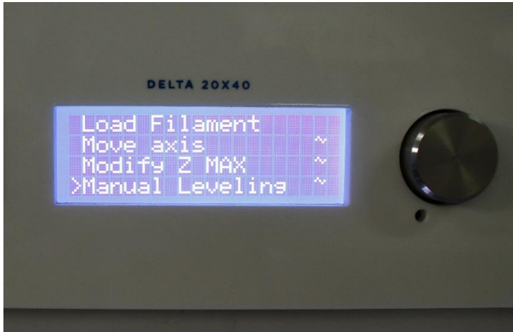
Imagen 73 Menú Prepare, donde se procede a nivelar la base
