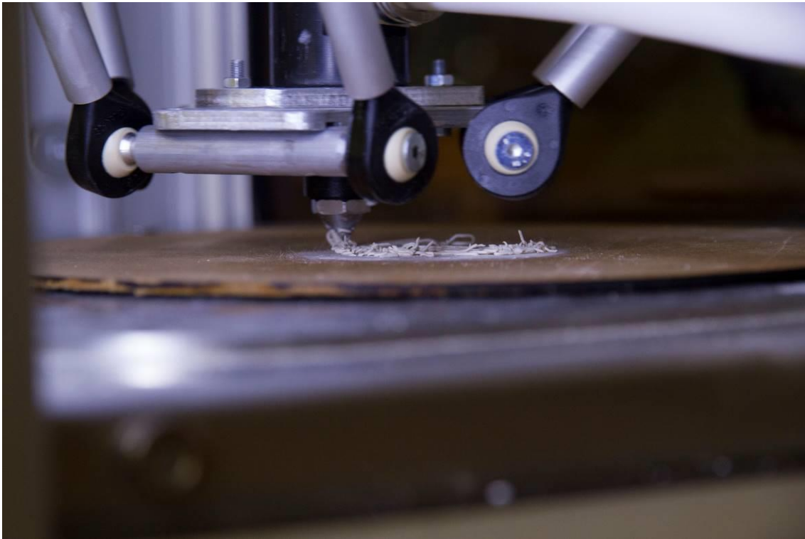
Imagen 93 Rotura de filamento
