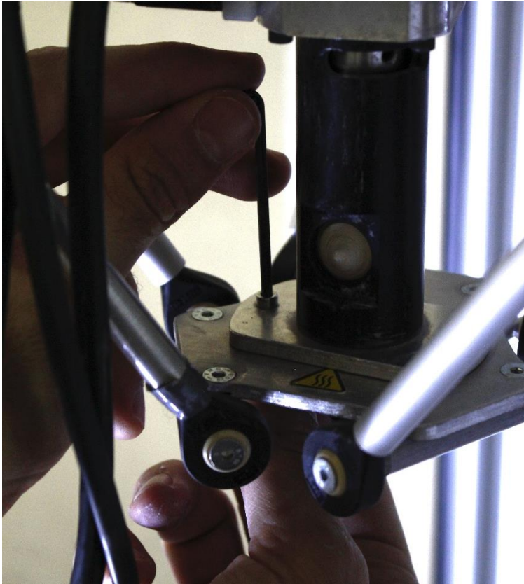
Imagen 63 Paso 3: Desconectar el extrusor y destornillar de la plataforma
