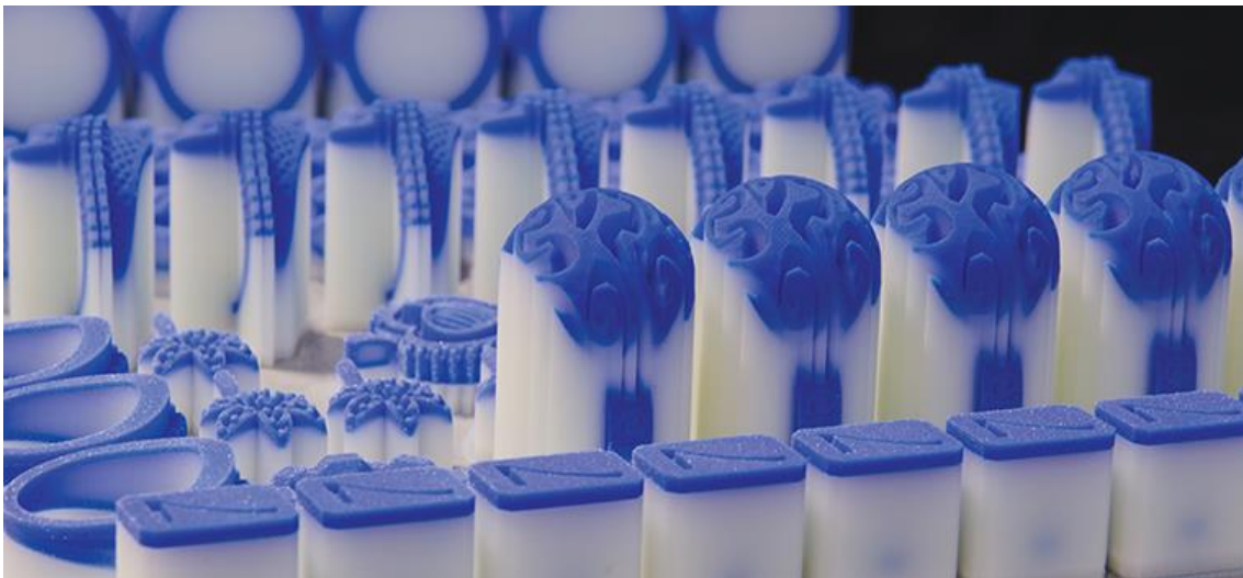
Imagen 10 Piezas impresas mediante MJP, donde las partes blancas son de cera y las azules de resina
