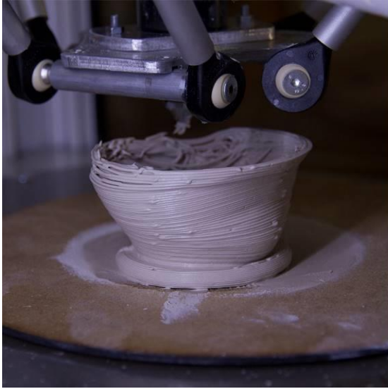
Imagen 99 Inicio de deformación Imagen 100.1 Derrumbamiento de la impresión 012518
