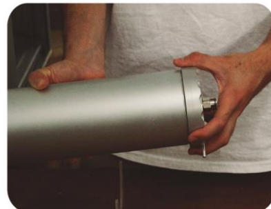
Paso 6: Procurando no dejar burbujas de aire, cerrar el depósito
