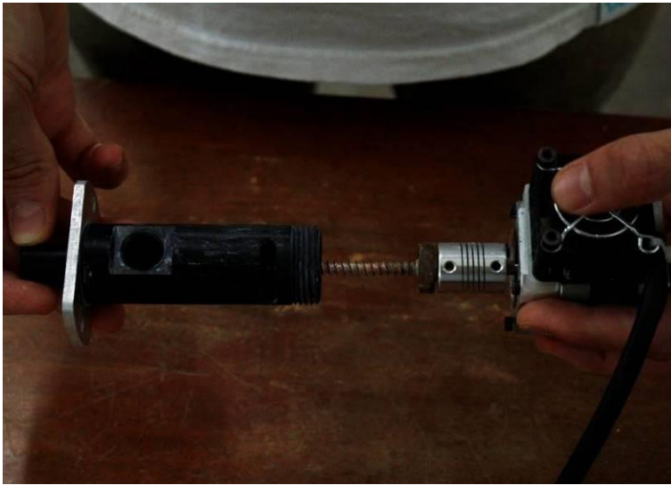
Imagen 48 Paso 1: Introducir tornillo sin fin en carcasa
