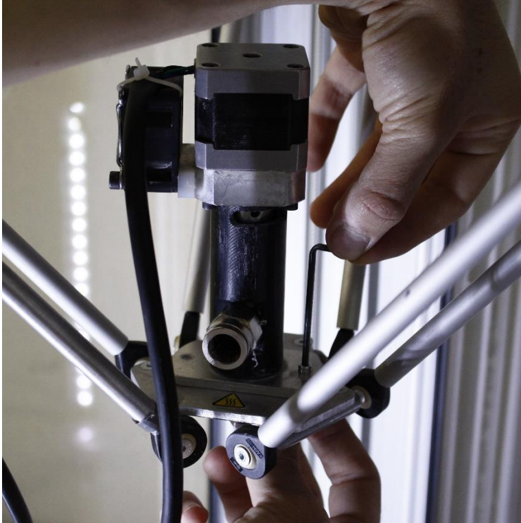
Imagen 52 Paso 5: Atornillar el extrusor a la plataforma
