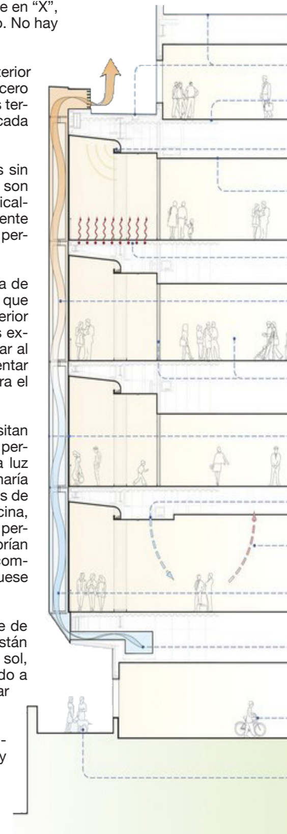
Figura 68 | Diagrama de la ventilación natural en la pared climática de Milstein Family Heart Center.. Fuente: Charles D. Linn.
