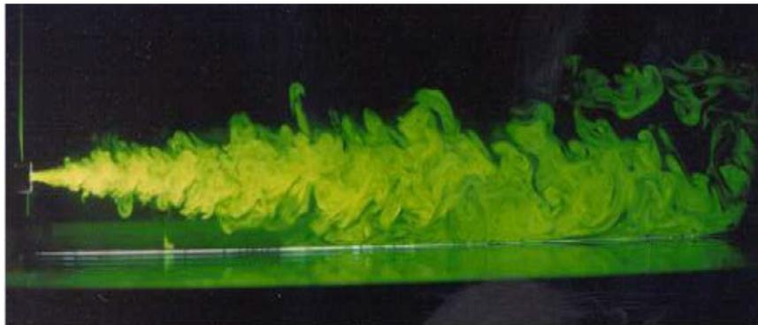
Figura 3.2: Chorro turbulento coloreado
