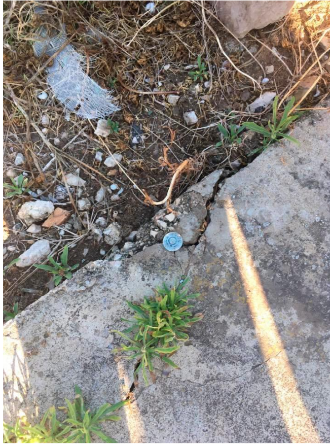
IMAGEN 9: CLAVO GEODÉSICO DE COORDENADA REPLANTEADA, SUECA
