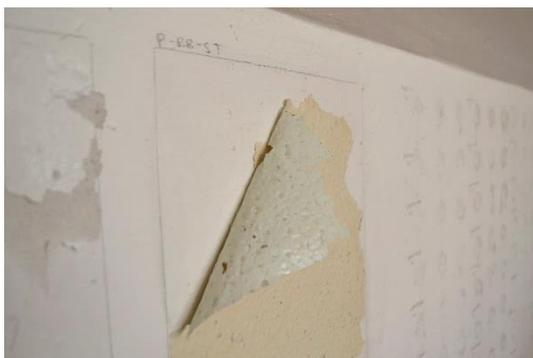
*Ilustración 16. Detalle de deficiencia adhesiva en probeta P-RB-ST.*
