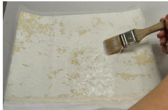
*Ilustración 10. Refuerzo de la pintura.*
