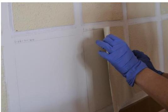
*Ilustración 15. Adhesión por contacto con Plextol<sup>®</sup>. Soporte pared.*
