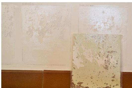
*Ilustración 17. Retirado de la probeta P-RB-PO-PX.*
