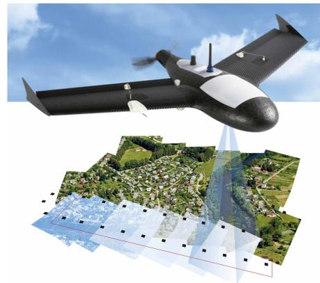
**Figura 3.1:** Dron de ala fija usado en fotogrametría
