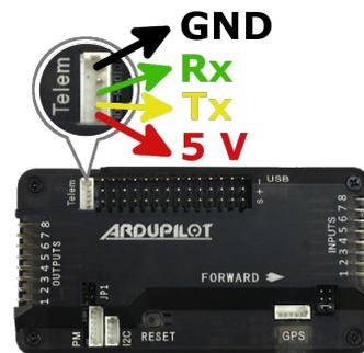
Figura 6.6: Ampliación del puerto de telemetría
