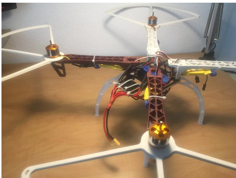
Figura 5.6: Estado de montaje del dron con los motores y ESC instalados
