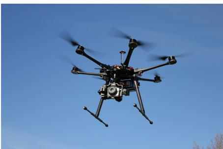
Figura 3.3: Hexacóptero utilizado en fotografía aérea
