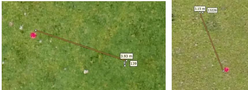
Fig. 64: Ejemplo de distancias entre marcador y punto de apoyo materializado sin ajustar.
