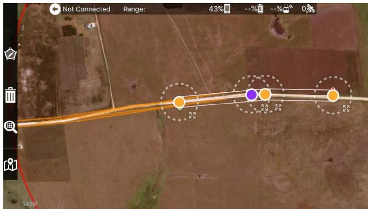
Fig. 47 Ejemplo de solape entre planes de vuelos.
