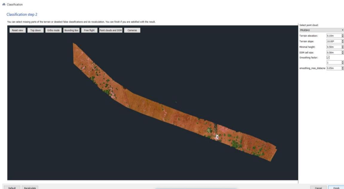
Fig. 79: Ejemplo de selección automática de puntos del terreno.
