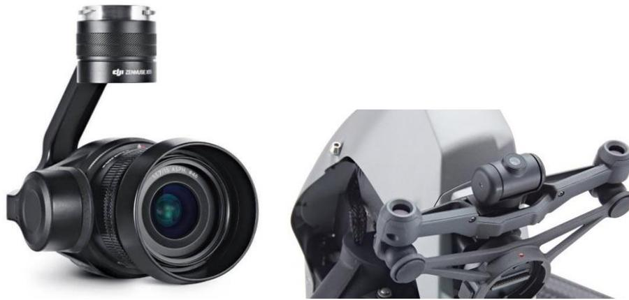
Fig. 30: Cámaras principal y secundaria del dron DJI INSPIRE 2. (Fuente: dji.com)
