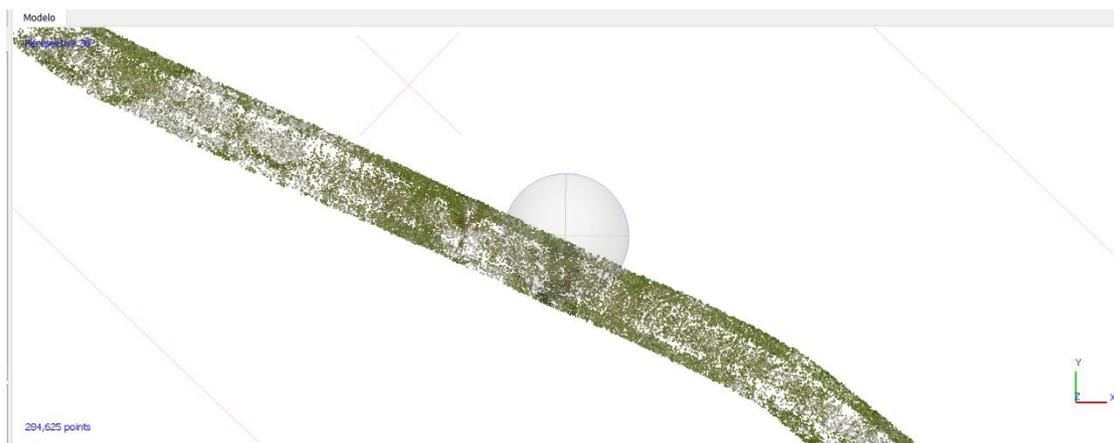
Fig. 54: Ejemplo de nube de puntos dispersa.
