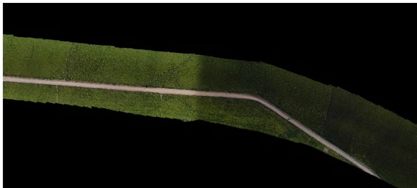
Fig. 38: Ejemplo de ortofoto afectada por cambios de luminosidad.
