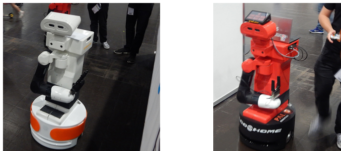
Foto tomada en la competencia de robótica “RoboCup 2016” en Leipzig, Alemania. Muestra a los robots de servicio comerciales de la empresa PAL robotics. No han competido en la RoboCup, están en venta para investigación y compañía. Utiliza un solo brazo manipuladora diferencia del robot Justina que incorpora dos.
