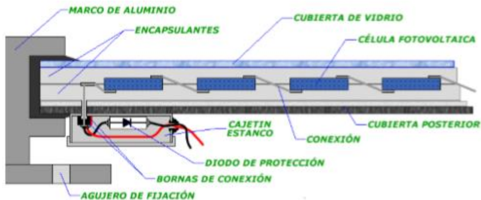
Ilustración 11 - Estructura de un módulo fotovoltaico estándar.
