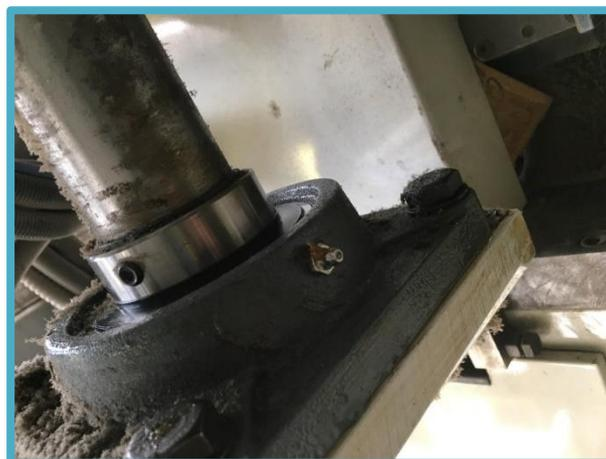
**57,58 y 59. Rodamientos eje transmisión correas salida.**
