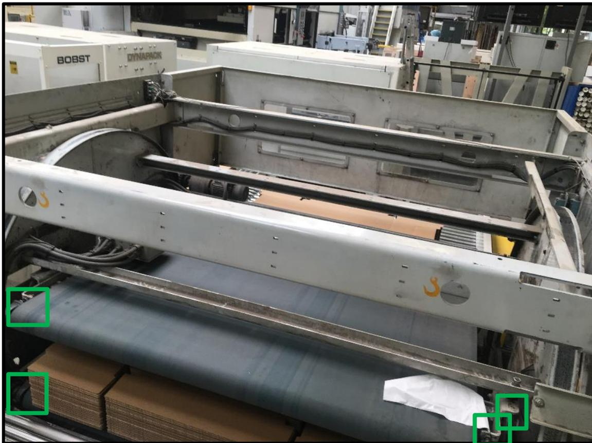
**NOTA:** En total hay 8 puntos de engrase, 4 en la zona posterior del volteador y 4 en la zona anterior. Son simétricos. En la siguiente página se adjunta foto del detalle. Además, hay 2 cadenas de accionamiento de las cintas en los dos laterales. Comprobar tensión y engrasar si fuera necesario.
