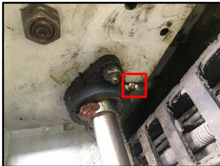
**51. Rodamiento eje paletizador LM.**
