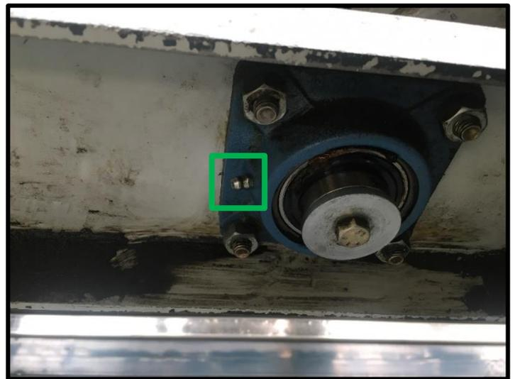
**53. Rodamiento eje transmisión correas.**
