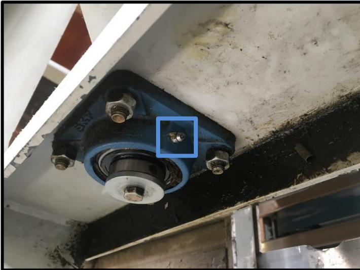
**52. Rodamiento eje paletizador LT.**
