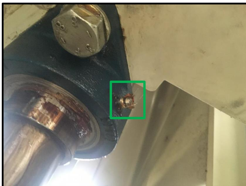
**24 y 25. Rodamiento eje movimiento del cajón. (INTRODUCCIÓN SPO-203)**
