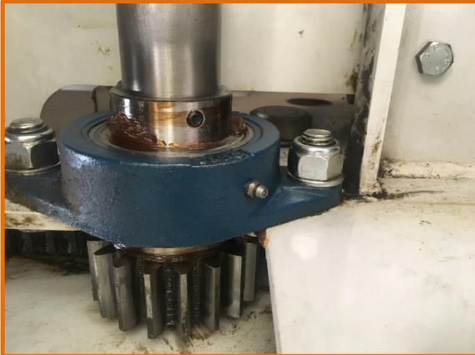
**41. Rodamiento eje transmisión LM.**
