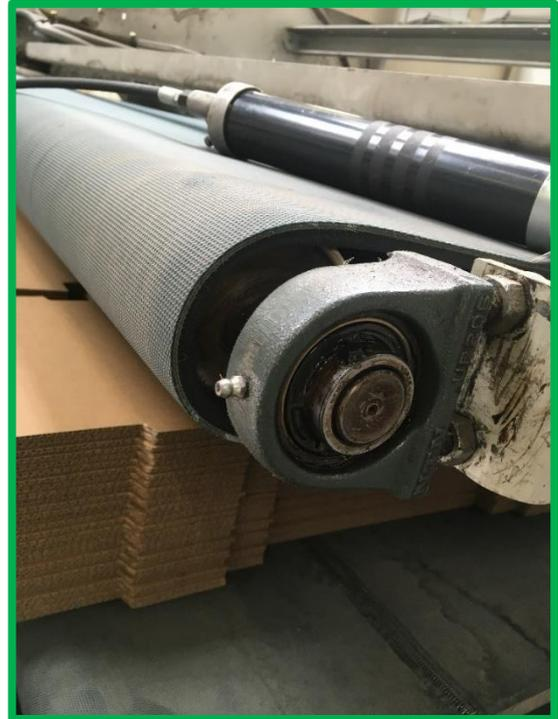
**64 y 65. Rodamientos eje transmisión cinta
