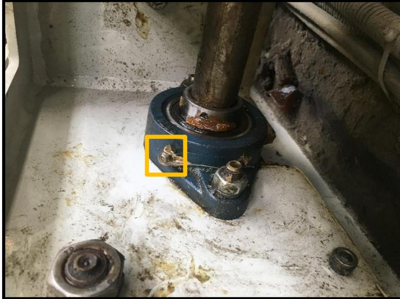
**50. Rodamiento eje posicionamiento POSTERIOR LM.**
