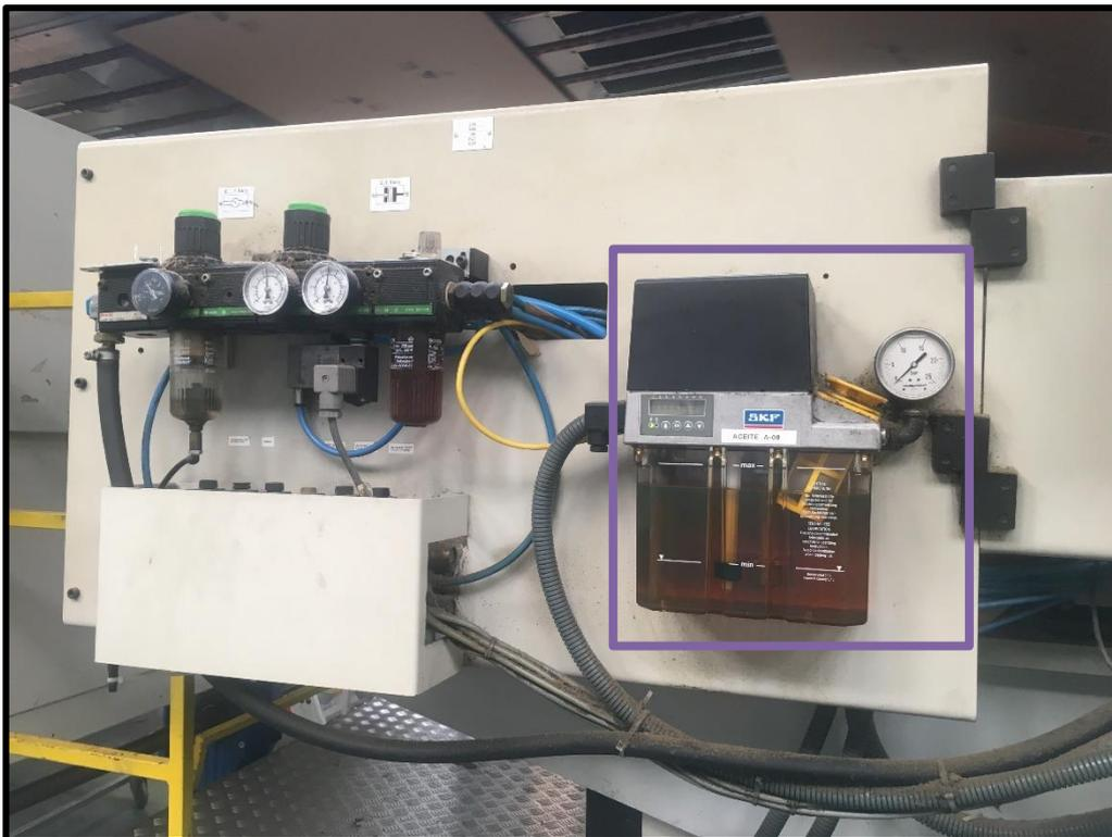
**\*NOTA:** Verificación del nivel de aceite. En el caso de que faltase aceite en el depósito, se enciende un LED rojo simultáneamente con el indicador de pantalla de máquina.
