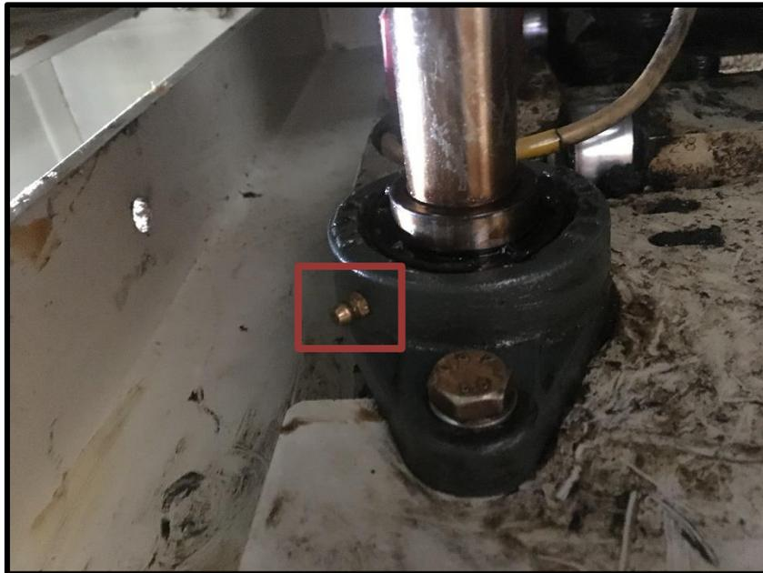
**23. Rodamiento del eje del carro empujador Lado Transmisión (INTRODUCCIÓN SPO-203).**
