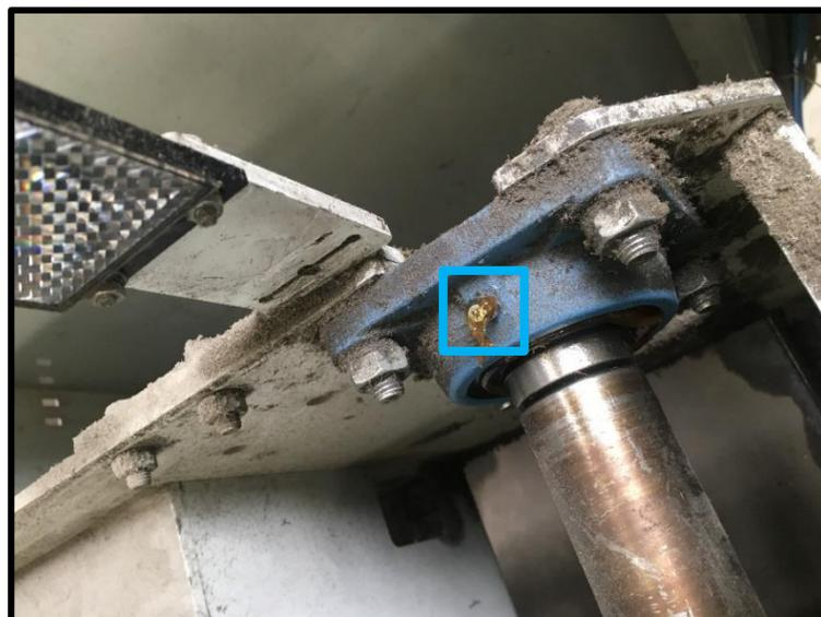
**49. Rodamiento eje posicionamiento POSTERIOR LT.**
