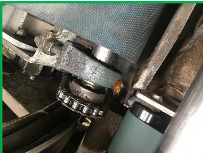
**66 y 67. Rodamientos eje transmisión cinta volteador
