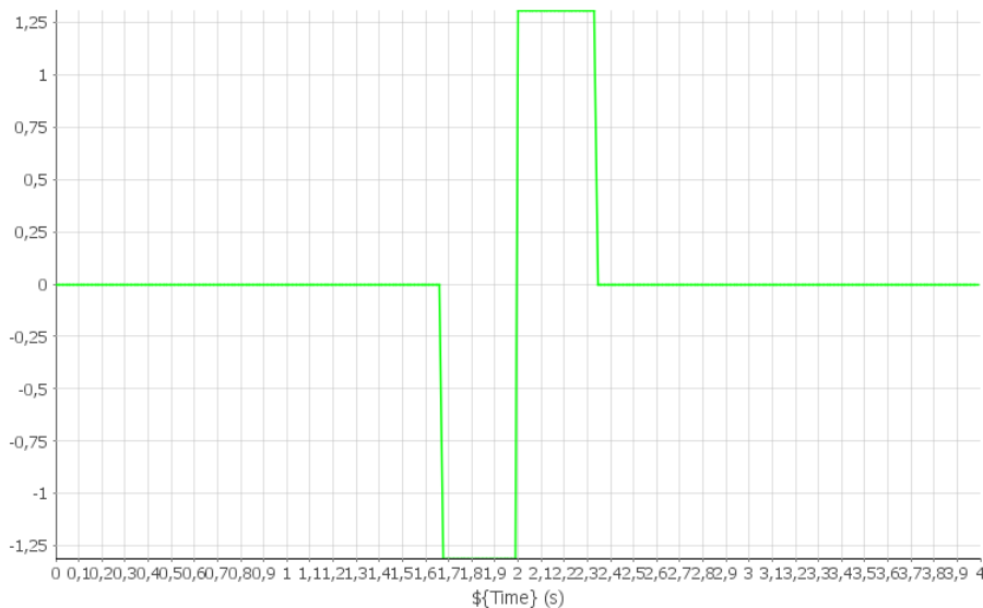
Figura 3.15: Velocidad angular sobre el eje Z del overset derecho
