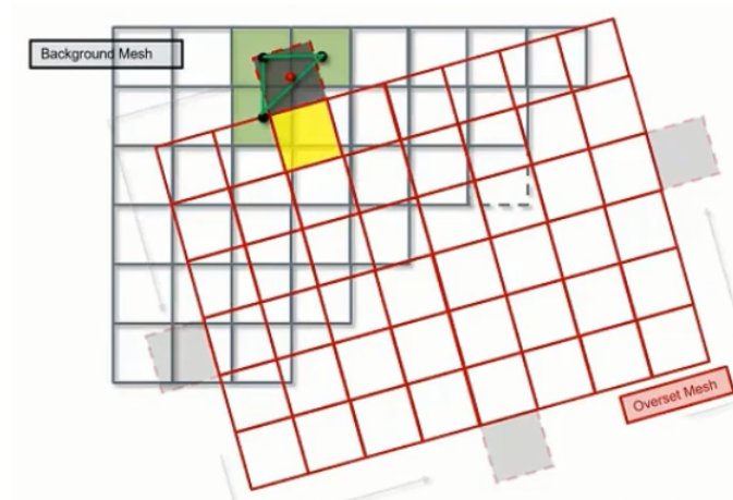
Figura 3.13: Interpolación de las soluciones entre una malla background y una malla overset
