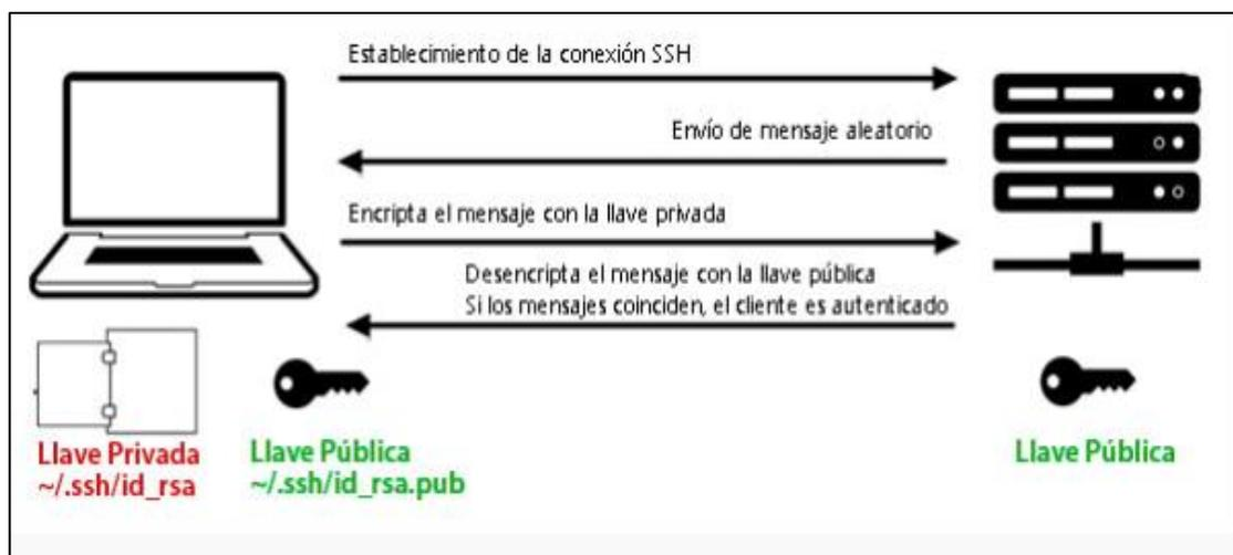
Fig. 2.17 Pasos para la conexión SSH [17]
