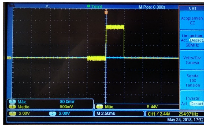
Ilustración 13: Señal salida segundo monoestable con ruido
