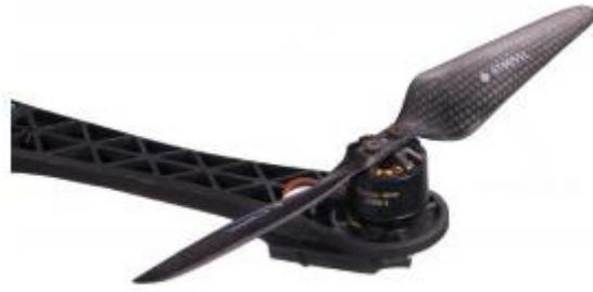
*Ilustración 7. Hélice montada en un motor. Fuente: [www.surehobby.com](http://www.surehobby.com)*
