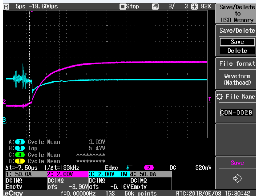
Figura 22: Medida del tiempo de respuesta de la batería número 2
